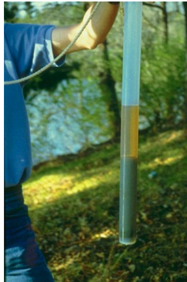
Figura 2. In situazioni particolari o in coincidenza di eventi incidentali prodotti idrocarburici possono raggiungere la falda in concentrazioni tali da costituire una fase propria. In base alla densità del prodotto rispetto a quella dell'acqua di falda, si possono formare dei veli (o dei veri e propri strati spessi anche diversi metri) che "galleggiano" o "affondano". Poiché le acque di falda sono in movimento esse costituiscono il vettore attraverso cui la contaminazione si diffonde fino a raggiungere aree sensibili (es. pozzi per approvvigionamento idrico, aree umide ecc.). Quanto sopra è esemplificato dalla ipotetica sezione di figura che evidenzia il galleggiamento di un prodotto oleoso il fase libera (cioè non più disperso in acqua), a destra lo stesso prodotto è rinvenuto in fase di campionamento chiaramente separato dalla fase acquosa. (da APAT 2007)
